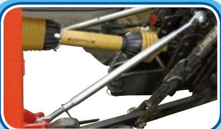
Telaio ad alta resistenza con predisposizione di fissaggio 3 punti al sollevatore di categoria 2 ed attacchi supplementari inclinati, per tenditori di fissaggio.
