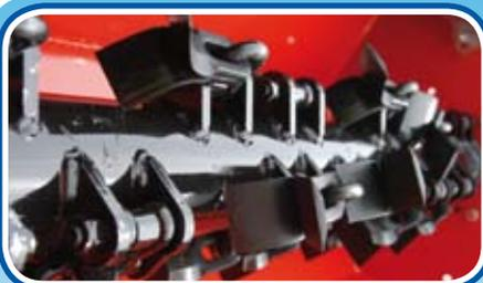
Rotore con coltelli ad Y di spessore 8 mm, montati su cavallotto con vite di fissaggio di 14 mm su 2 supporti saldati (grande flessibilità ed ottima triturazione). Il rotore non si squilibra.
