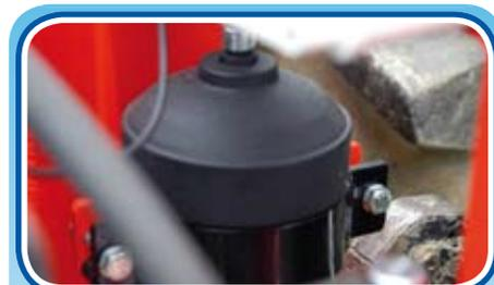
Ammortizzatore idropneumatico (con accumulatore d'azoto) per la salvaguardia della macchina contro eventuali ostacoli, e per il confort del rientro automatico in posizione.
